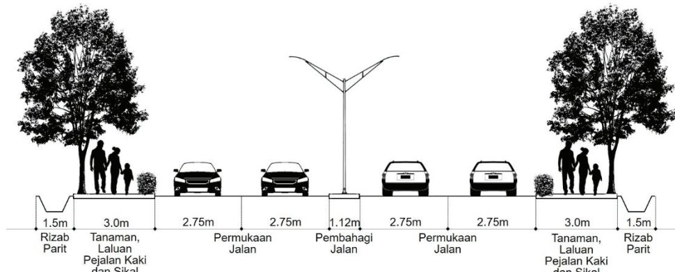
Rajah 4: Keratan Rentas Rizab Jalan Pengumpul Kecil Empat Lorong Dua Hala (20.12 meter / 66.01 kaki).
